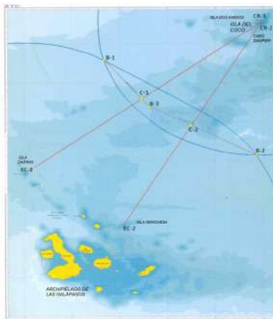
Figura 9. Modelo geodésico para la definición de los límites marítimos entre la República de Costa Rica y la República de Ecuador.
