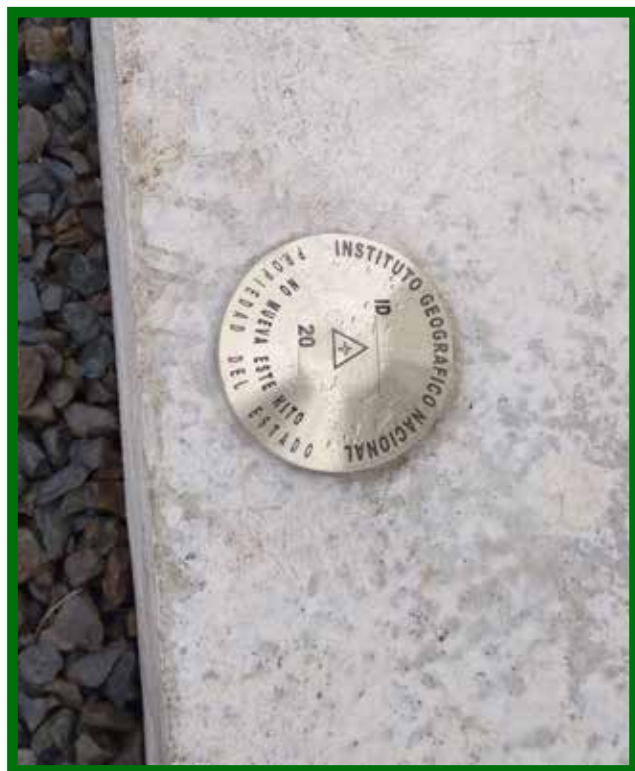
Figura 6. Placa localizada en la estación GNSS CAPO Fuente: Carlos Eduardo Gómez Salazar, IGN proceso de instalación sitio CAPO, Cariari de Pococí, Guápiles Limón.
