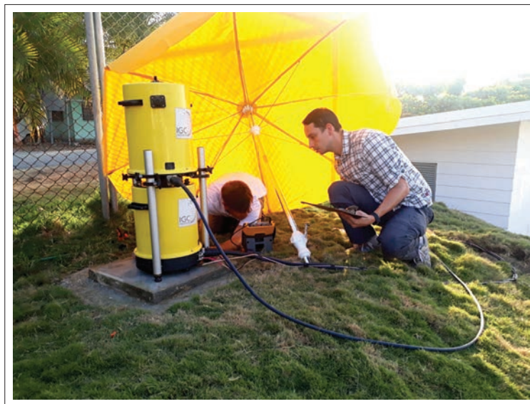
Figura N°15. Medición de la gravedad en Quepos Fuente: fotografía Ing. Alonso Vega.
