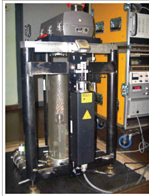
Figura N°9. Gravímetro absoluto IMGC-02 desarrollado por INRIM Fuente: Tomado de reporte (D'Agostino, Germak, Claudio, Quagliotti, & Desogus, 2008).
